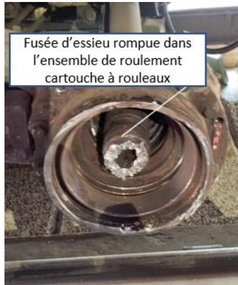
Figure 7. Ensemble de roulement cartouche à rouleaux de endommagé, position n° 3 sur l'essieu B (Source : BST)
