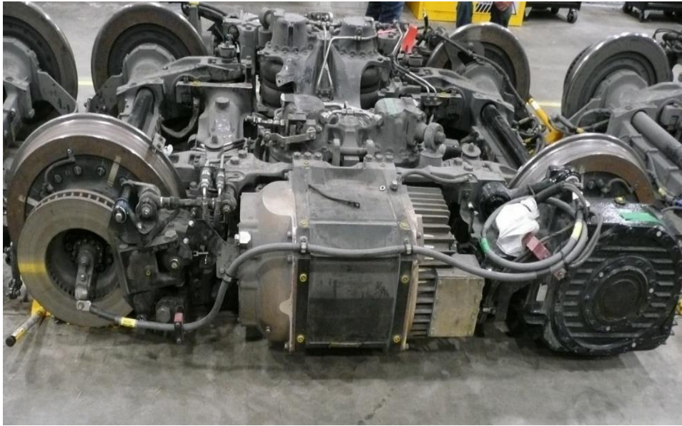
Figure 2. Bogie moteur Iponam d'un VLR d'Alstom (Source : BST)
