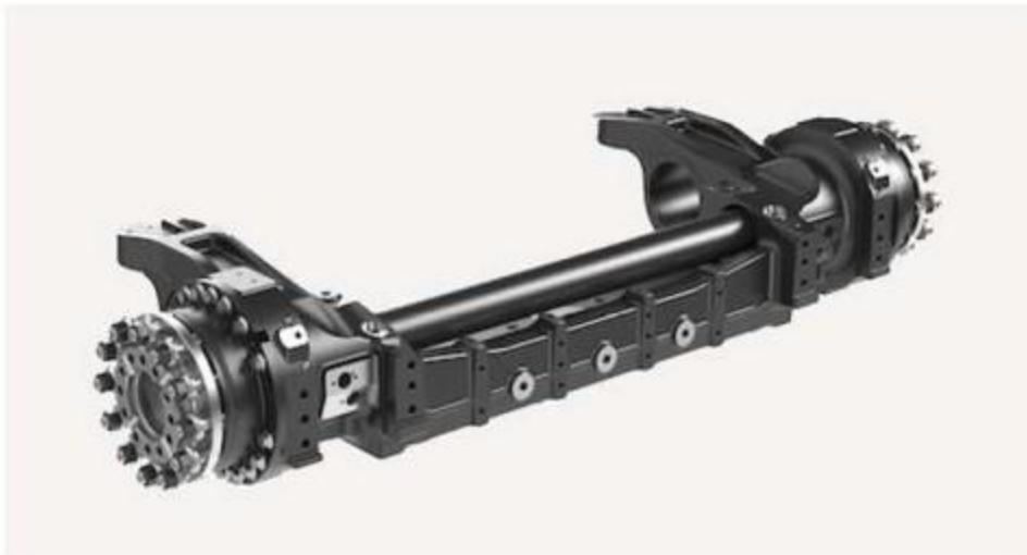
Figure 3. Ensemble d'essieu du bogie Iponam (Source : Alstom)
