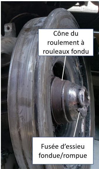
Figure 6. Assemblage de la roue et de l'essieu sectionnés à partir de la position n° 3 (Source : BST)
